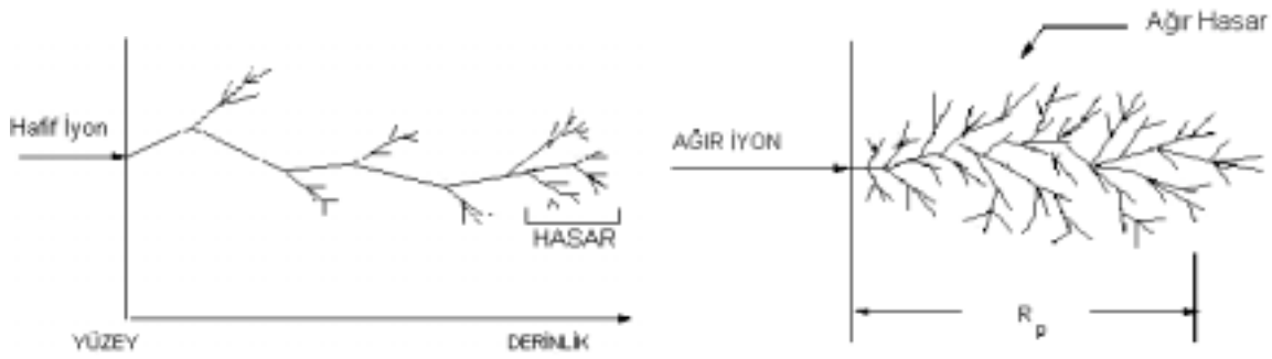
Şekil 5. Hafif ve ağır bir iyon tarafından oluşturulan hasar
