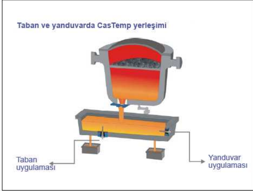
řekil 1: CasTemp yerleřtirme pozisyonları
