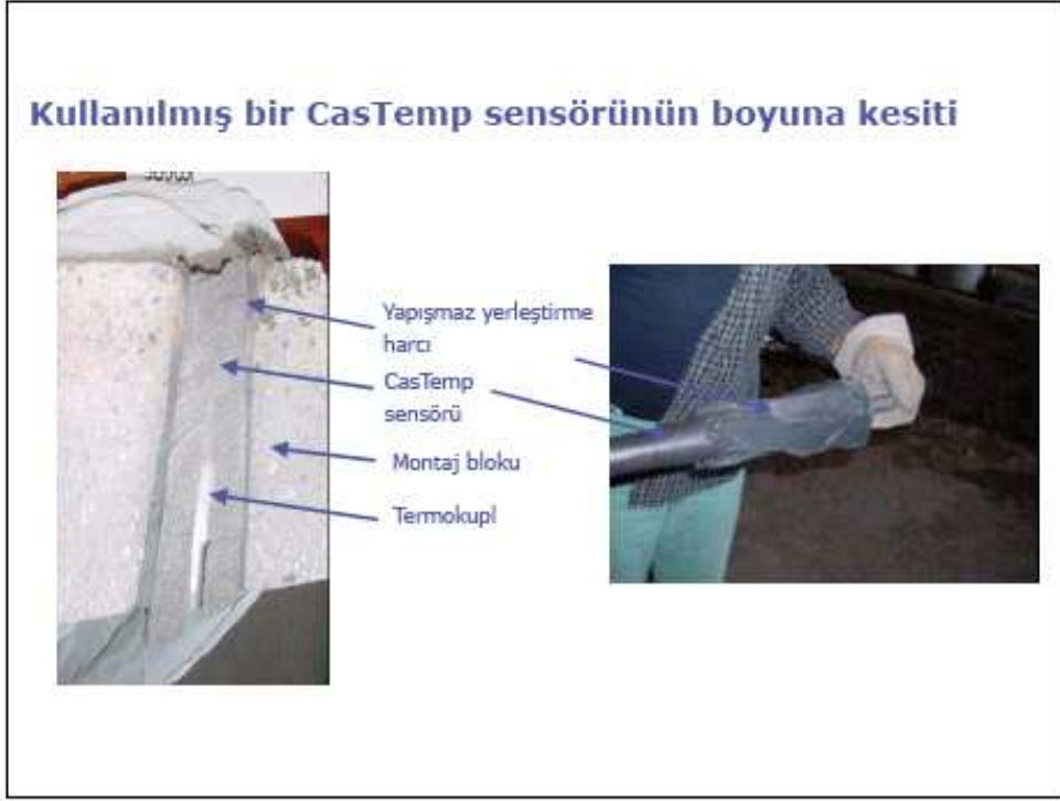
Şekil 4: Kullanılmış bir CasTemp sensörünün boyuna kesiti
