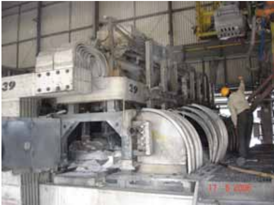
Şekil 11: 320 kA Prebaked hücre –Aostar-Çin
