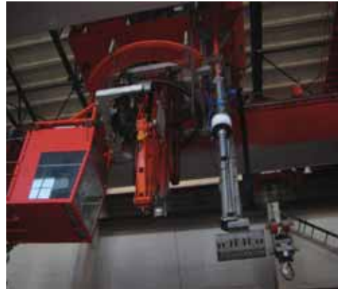
Şekil 15: Çok fonksiyonlu hücre hizmet vinci, Shenyang Metalurji-Çin
