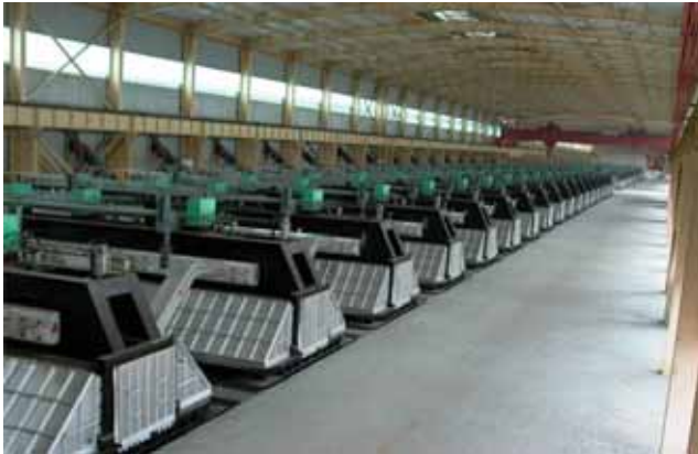
Şekil 14: GAMI tarafından tasarlanmış 360 kA Prebaked hücre
