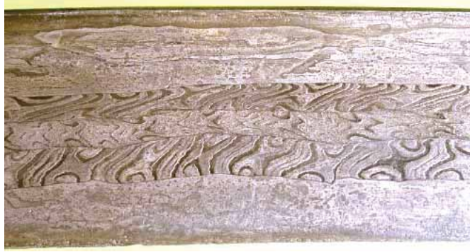
Resim 4: Sıcak dövüme kaynağı ile yapılan Kılıç namlusu (yatağan denilen kılıç namlusu)
