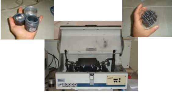
Şekil 2: Spex 8000 D Mikser değirmen, paslanmaz çelik öğütücü kavanozu ve bilyalar
