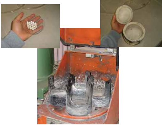
Şekil 3: Fritsch Pulveritte 4 hazneli bilyalı değirmen, öğütücü kavanozu ve bilyalar
