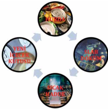
Şekil 3: Tipik kapalı döngü yeniden değerlendirme Novelis'de yaklaşık 1.5 milyon adet kullanılmış alüminyum içecek kutusunun yeniden ergitilmesi ile üretilen 27 ton ağırlığında, 9x1.8x0.5 metre boyutlarında slabın sıcak haddelenerek yeniden içecek kutusuna çevrilmesi.
