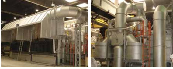
Şekil 7: Modern ergitme sistemleri: İki kamaralı ergitme fırını ve Rejeneratif yanma sistemi (Sistem Teknik)
