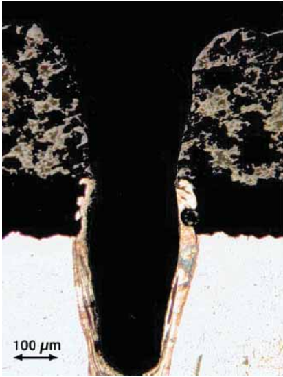
Şekil 4: Tipik bir TBK sistemi lazer ile delme prosesi sonrası mikroyapı ve metalurjik oluşumlar[19]
