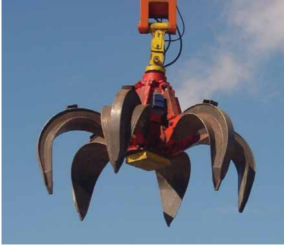
Şekil 3. Polip İçine Yerleştirilen Radyasyon Tespit Sistemleri
