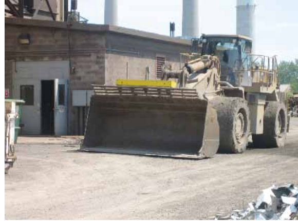
Şekil 4. Farklı Uygulamalar İçin Bant Sistemine ve İş Makinası Kepeğine Yerleştirilen Radyasyon Tespit Sistemleri
