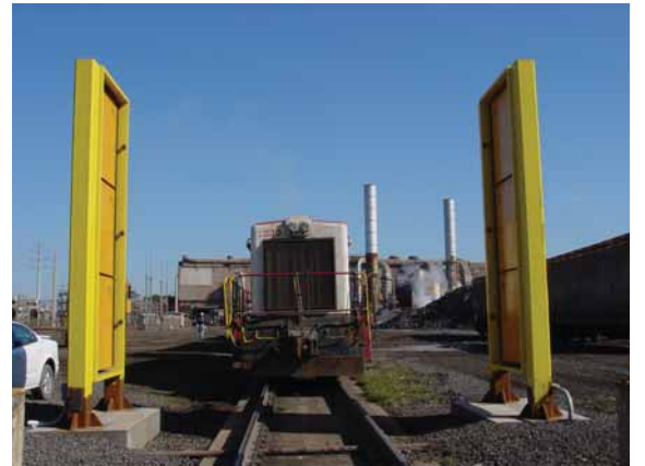
Şekil 2. Demiryolu için Panel tipi Radyasyon Tespit Sistemleri
