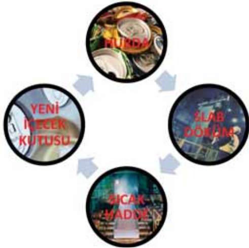
Şekil 3: Kapalı döngü yeniden üretim (alüminyum içecek kutuları için)
