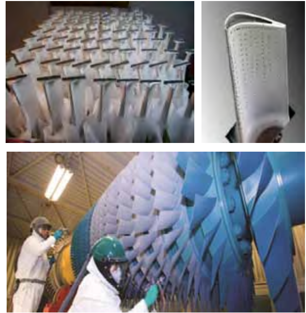
Şekil 17: Gaz türbin moturu kanatçıkları (termal bariyer kaplamalı)
