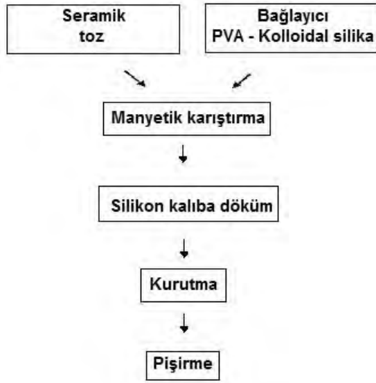
Şekil 1. Seramik esaslı ön şekillerin üretim süreci [11]
