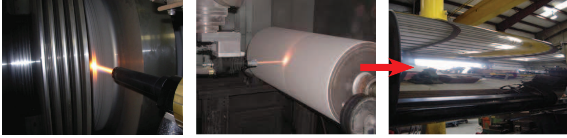
HVOF kaplama uygulaması esnasında (dar bölgeleri kaplama kabiliyeti, Şekil 10. HVOF Kaplanmış yüzey ve ardından parlatılmış yüzey görüntüsü
