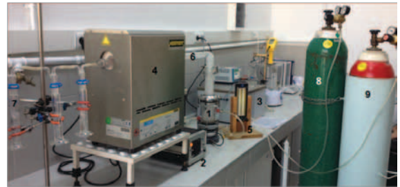
Şekil 1: Deneysel düzeneğinin genel görünümü 1)Atomizör 2)Atomizör güç kaynağı 3)Soğutma sistemi 4)Fırın 5)Akış ölçer 6)Kuvars tüp 7)Toz toplama şişesi 8)Azot gazı 9)Hidrojen gazı
