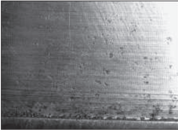
Şekil 10. Kalıp yüzeyinde kavitasyonun görüntüsü
