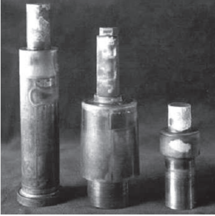
Şekil 8a. Korozyon-Erozyon(Yapışma-Soldering) Hasarlarından Örnekler
