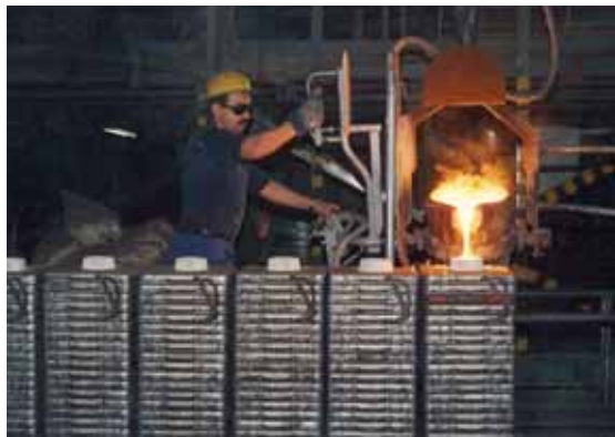
Şekil 5: Dizilere segman eriyiğinin dökümü,dizi döküm yöntemi
