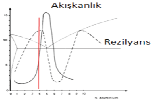
Şekil 3: Zn-%4Al alaşımının özellikleri [3,4]
