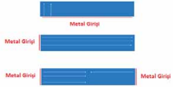
Şekil 6: Aynı parça üzerinde farklı metal girişleri a)ideal b)tavsiye edilmeyen c)tavsiye edilmeyen [4]
