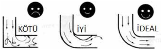
Şekil 7: Kalıp tasarımında keskin-dik köşelerden kaçınılmalıdır [3,4].
